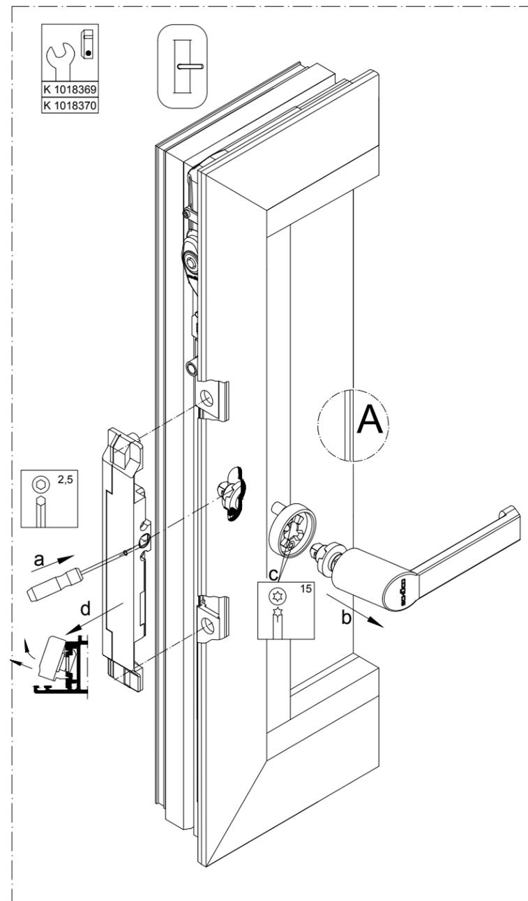
1. Démontez la poignée de fenêtre avec la rosette et la crémone de verrouillage encastrée.
