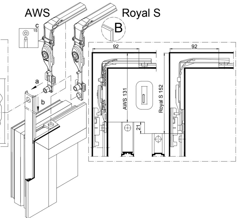
1. Accrochez le renvoi d'angle en partie supérieure de la barre de verrouillage côté poignée et l'insérez dans la rainure de ferrage.
