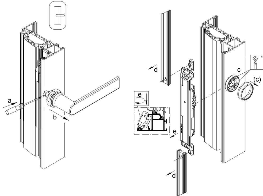
1. Mettre la poignée de fenêtre en position à la française. Enfoncer le tournevis dans le trou pour pousser le cran, jusqu'à ce que la poignée de fenêtre s'éjecte, ou l'extraire en forçant un peu.
